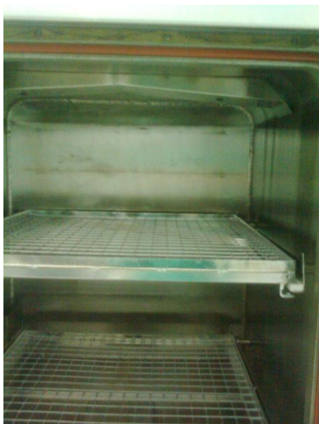
Figura Nr. 6. Rafturi în incinta de sterilizare a autoclavului.
